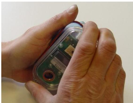
ゴムの O-Ring を外して、接着剤のシリコンをしっかりと除去します。小さいな定規や細いドライバを使います。
