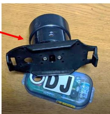
吊り下げタイプはサン・スーシ特製のホルダを使用します。主に OMM で使用していますが、通常の大会でも使用が可能です。その場合は差し込みパンチに時間がかかるので、タッチフリーでお勧めです。
